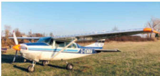
Das Flugzeug nach der Umrüstung – zu erkennen die Flächenverlängerung, die Vortex Generatoren auf der Flügeloberseite und der neue Propeller.
